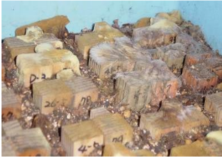
ファンガスセラー（腐朽槽）
