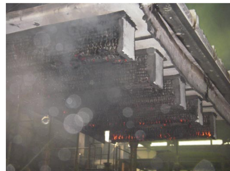
写真1 加熱終了直後の試験体の状態
