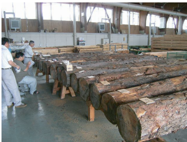
重点研究課題「カラマツ大径材による建築用材生産技術の検討」より、心去り平角材の木取りを検討中
