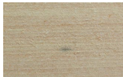
写真2 中心が濃く見える刃こぼれによる鉄汚染
