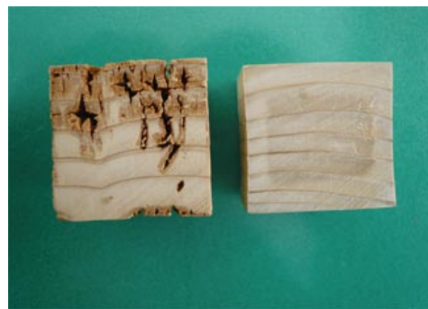
写真2 腐朽試験後の劣化状況 (左:無処理材, 右:アセチル化材, 樹種:トドマツ, 試験期間:4か月, 木口断面にて観察)
