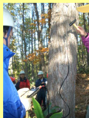
写真3 応力波伝播速度の測定
