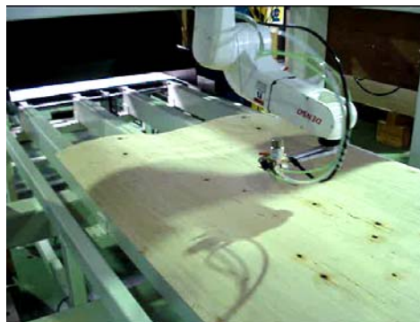
写真2 節脱落防止処理装置
