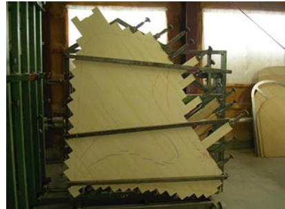
写真2 グランドピアノ響板の幅はぎ
