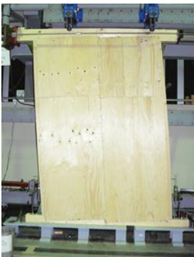
写真3 水平せん断試験
