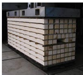
写真1 栈積みの状況
