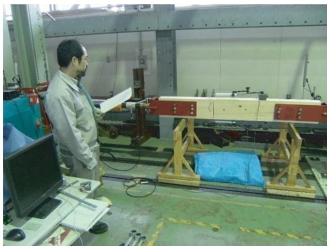
研究テーマ「道産材を用いた伝統的接合部の強度性能評価」より、『追掛け大栓継ぎ』を施した梁（トドマツ材）の引張試験
