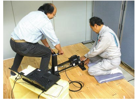
写真3 携帯型床の滑り試験機による試験
