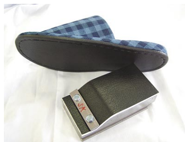
写真2 滑り片の一例（スリッパとその滑り片）
