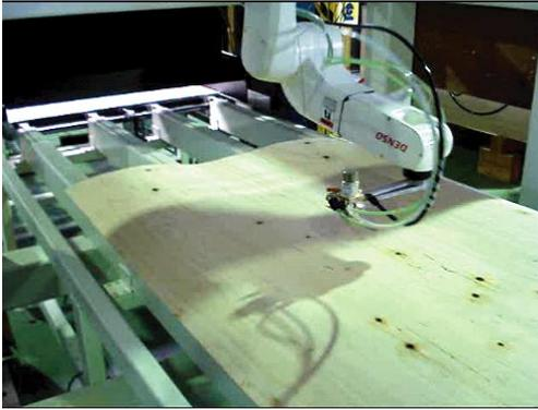
写真3 節脱落防止処理装置
