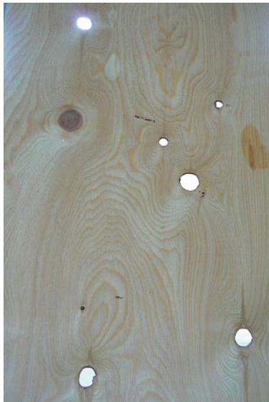
写真1 節の抜け落ちた単板
