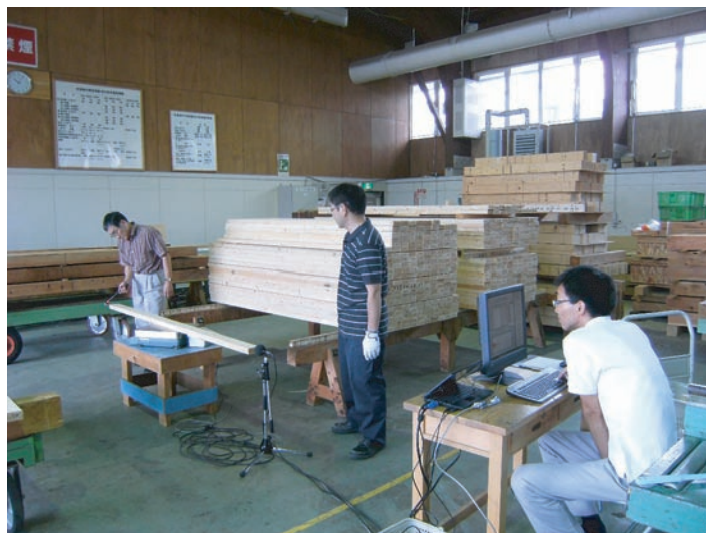
2×4製材のヤング係数を打撃法で測定中 (林産試験場生産試験棟、平成23年8月17日)
