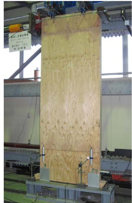
写真2 耐力壁の面内せん断試験
