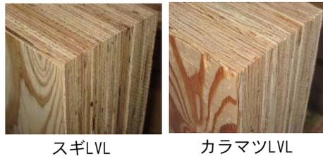
LVL厚板壁は、既存の筋かい壁や合板釘打ち壁と比べて、強く変形しにくいのは明らかですが、その性能を十分に発揮させるには、建物の基礎との接合耐力が重要となります。そこで、通常は単独で使われているホールダウン金物を複数使う方法と、新開発した高強度金物を使う方法を検討しました。柱脚接合部の引張試験（写真1）の結果、いずれもホールダウン金物が単独の場合に比べて2倍程度の性能を有することが確かめられました。
