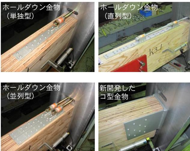
写真1 柱脚接合部の引張試験
