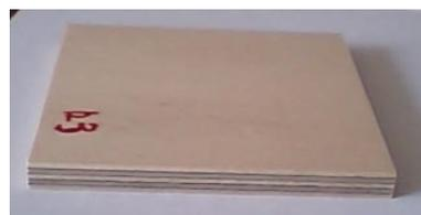
写真1 電磁波シールド合板
