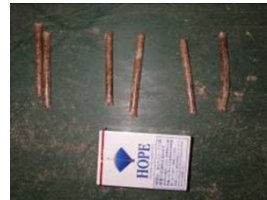
写真1 長いペレット ※搬送装置の詰まりの原因
