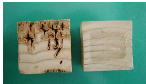
写真2 腐朽試験後の劣化状況 左：無処理材、右：アセチル化材、樹種：トドマツ、 試験期間：4 か月、木口断面にて観察（林産試だより 2010 年 8 月号より）
