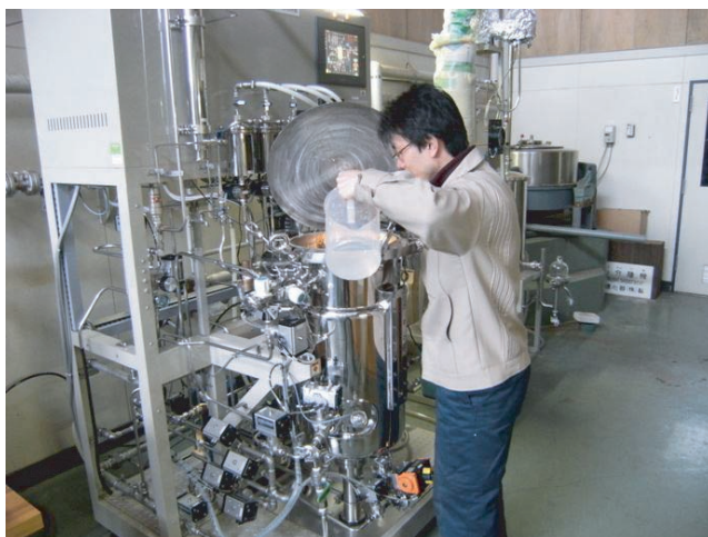
研究課題「木質系バイオマスからのエタノール等生産実証調査」より、栽培ヤナギを原料にエタノールの製造実験中：発酵槽の水分調整（林産試験場エネルギー試験室）
