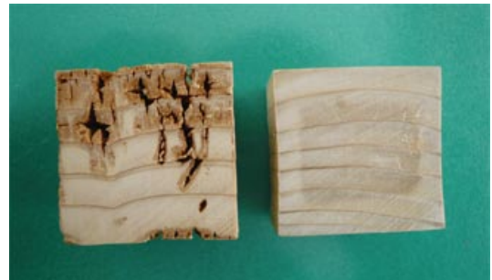
アセチル化木材(右)と無処理材(左)の劣化状態の比較(トドマツ材使用, 腐朽試験4か月後。林産試だより2010年8月号より)
