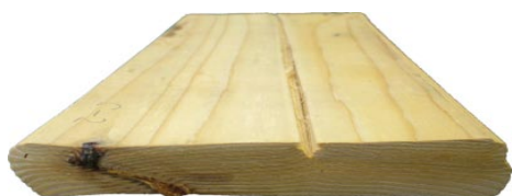
写真 2 横拘束なしで圧縮した場合の変形と裂け目
