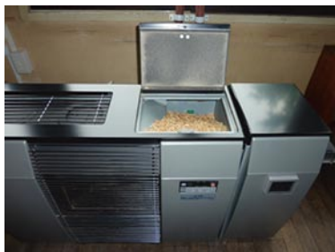
写真2 ペレットストーブのタンク
