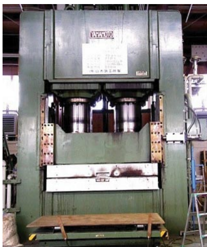
写真 1 試験生産用ホットプレス (蒸気加熱式, 熱盤 1×2m, 最大 1,200 トン)
