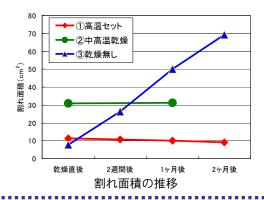
材1本あたりの割れ面積は、高温セット乾燥材では中 高温乾燥材の約3分の1,乾燥無し(2ヶ月経過後)の約 7分の1と、割れの抑制が見られました。
