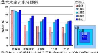
高温セット乾燥材における平均含水率および水分傾斜の推移
