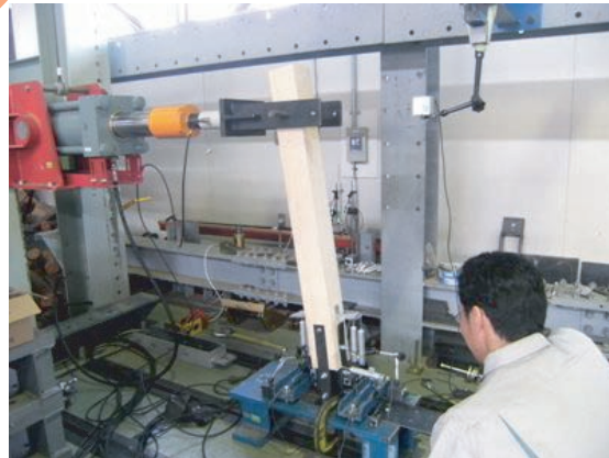
重点研究「木製遊具における安心・安全と長寿命化に関する研究」より、考案した柱脚用金具の性能試験（平成24年6月25日、林産試験場構造試験室。本誌今月号の1～2ページが関連記事になります）
