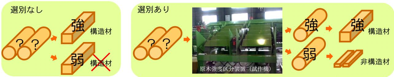
強度選別を行うことで、強度が重視される構造材や集成材ラミナを選択的に強い原木から採材することができるので、不良品の発生が少ない合理的な生産が可能になります。
