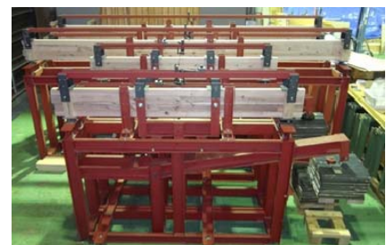
クリープ試験の様子 (手前：せん断クリープ、奥：曲げクリープ)
