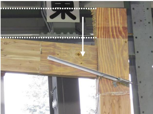
写真4 梁の曲げ破壊後の様子
