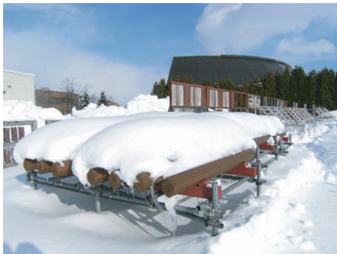
北海道型木製防護柵「ビスタガード」の耐候試験 (平成24年1月24日, 林産試験場耐候試験地)
