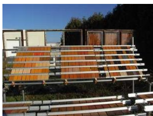
写真1 屋外暴露試験 （暴露地：旭川市）
