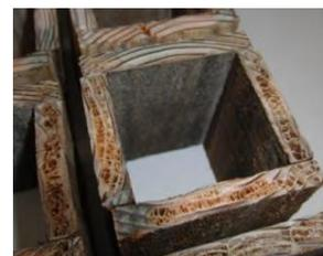
内部断面の腐食状況
