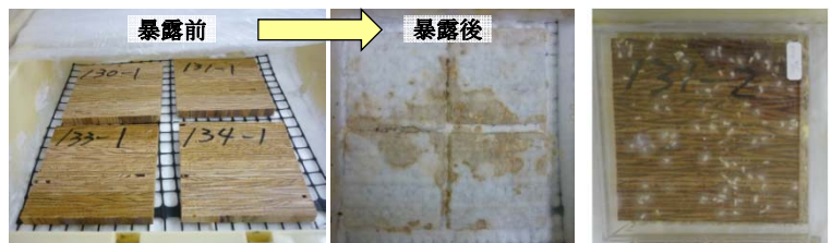
実大断面防腐試験
