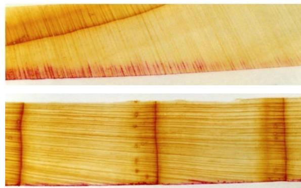
写真5 カラマツ 35℃乾燥心材の半径方向、接線方向の浸透
