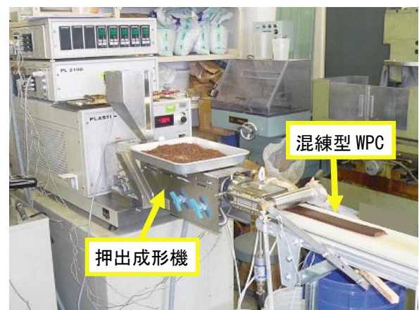
写真 3 混練型 WPC が押出成形機から押し出される様子
