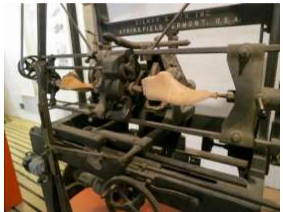
写真19 靴型を製造する当時の機械
