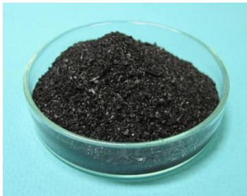
写真1 木質アンモニア、セシウム、ストロンチウム吸着材
