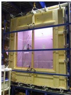
試作サッシの耐風圧試験 (強度試験)
