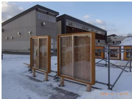
試作サッシの屋外暴露試験
