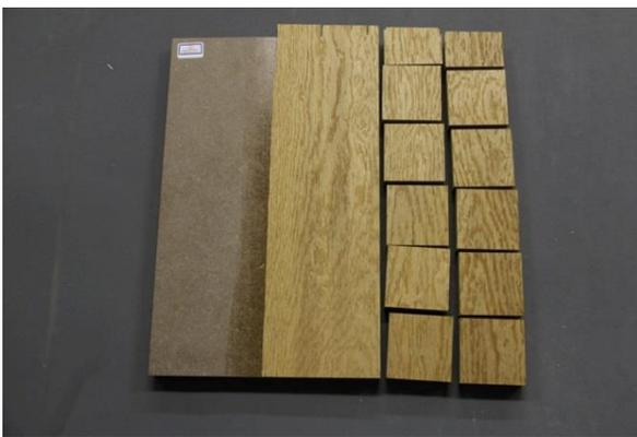
写真1 ミズナラ突き板単板，MDF試験片
