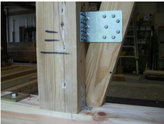
図4 ねじを用いた接合
