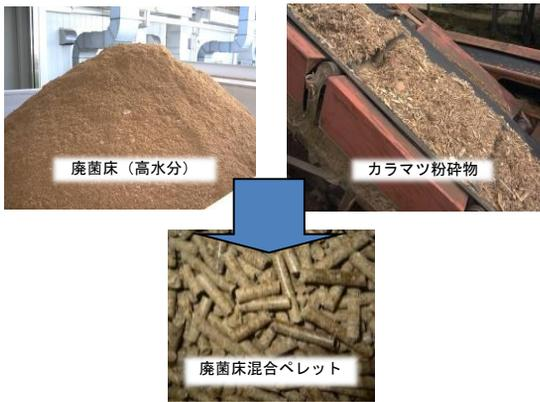
図3 廃菌床を水分調整材としたペレット
