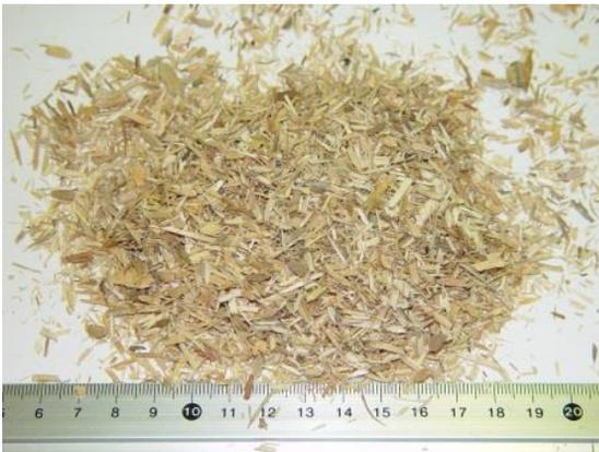
図3 建築解体材ピンチップ
