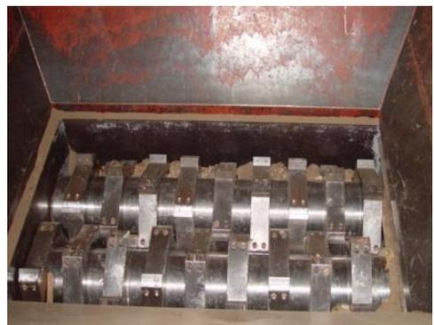
図1 2軸式せん断破碎機の破砕部
