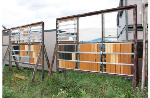
図2 屋外暴露試験の様子
