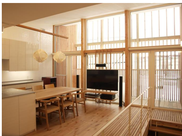
写真25 相反する要件を満たす複数のレイヤー（層）を持つ開口部
