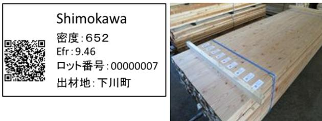
図2 左図：製品に貼付する生産履歴情報ラベル
