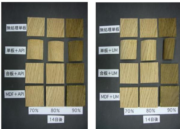
図2 ナラ材単板、MDF接着試験片の変色の様子
