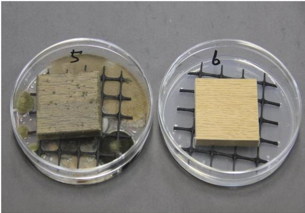
図4 寒天培地を用いた変色試験（14日後）
