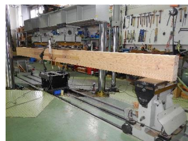
図5 集成材の曲げ試験の様子
