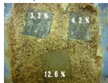
写真3 12週腐朽処理したMDF (数値は質量減少率)
