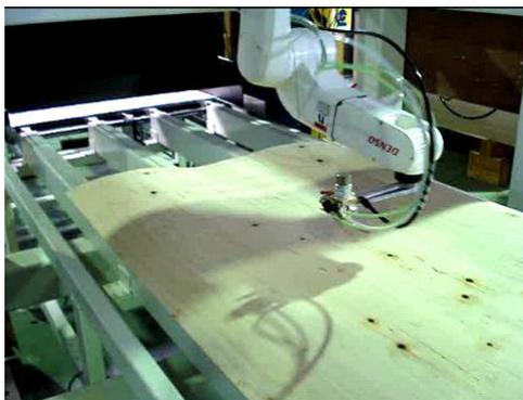
【節脱落防止処理装置】
