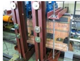
L形せん断金物試験 ＜壁と床のせん断接合＞
