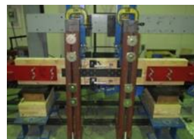
帯形引張金物試験 ＜1F壁と2F壁の引張接合＞
