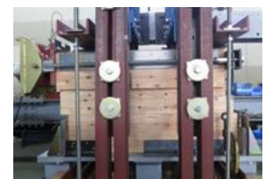
スプライン接合試験 ＜床と床のせん断接合＞
