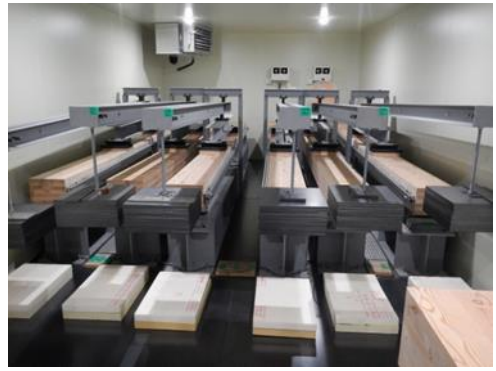
写真11 長期荷重試験の様子
