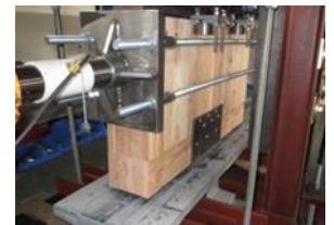
U形せん断金物試験 ＜基礎と壁のせん断接合＞
