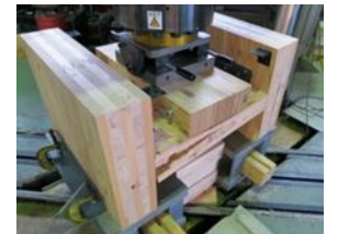
L形せん断金物試験 ＜壁と床の面外せん断接合＞
