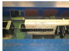
U形引張金物試験 ＜基礎と壁の引張接合＞
