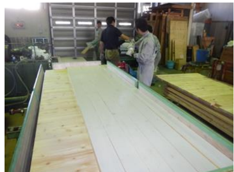
写真3 合板プレスを用いた実大パネル製造試験
