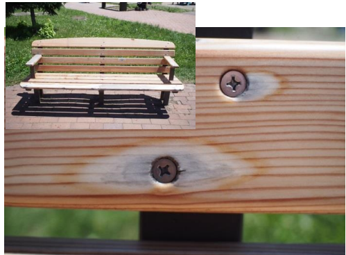
図1 木製ベンチにおける、塗膜の上からネジ止めした際の変色事例
