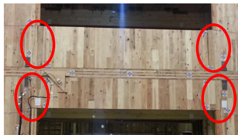
写真2 大地震時に「大版パネル架構①」で許容する開口部上下（腰壁部、垂れ壁）とその両袖の割れ（E-Defence加震実験より）
