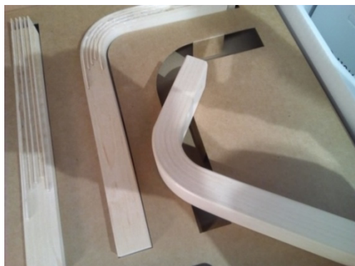
写真13 曲げ木の製造方法
