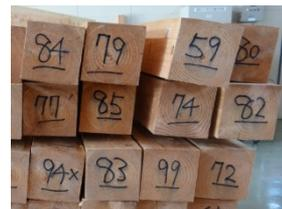
図1 コアドライ乾燥によるねじれ
