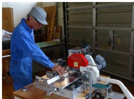
【小型試験片鋸断装置による作業の様子】
