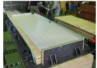
図2 道産CLT製造試験
