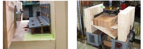
ビスの引抜け CLT内層の割れ 破壊の様子
