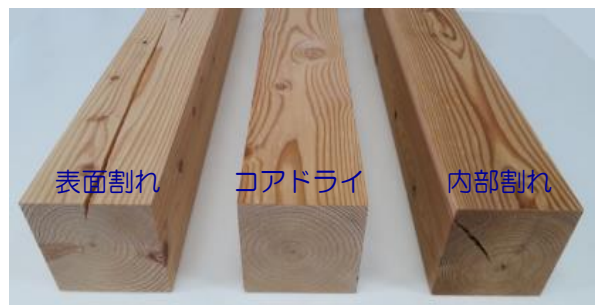
写真2 コアドライ材と割れのある材の比較
