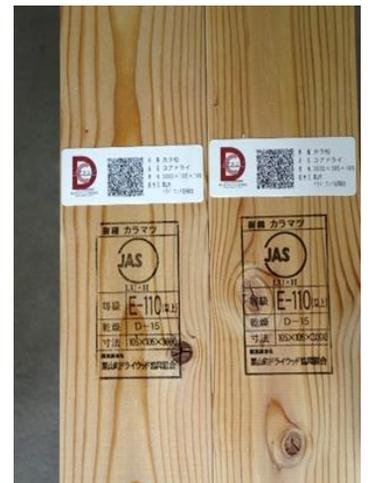
写真7 機械等級区分製材の一例
